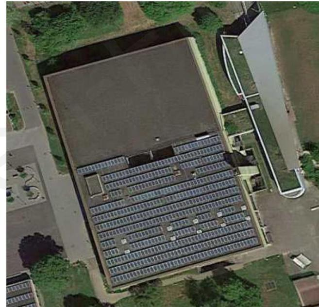
Das Dach der Festhalle wurde vor ca. 6 Jahren komplett saniert und mit einer Photovoltaikanlage belegt. Das Dach der Sporthalle ist alt und es kommt lt. Auskunft des Hausmeisters regelmäßig zu Wassereintritten an unterschiedlichen Stellen.
