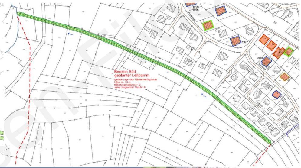
Leitdamm und Retention zur Pufferung und gezielten Ableitung des Oberflächenabflusses
