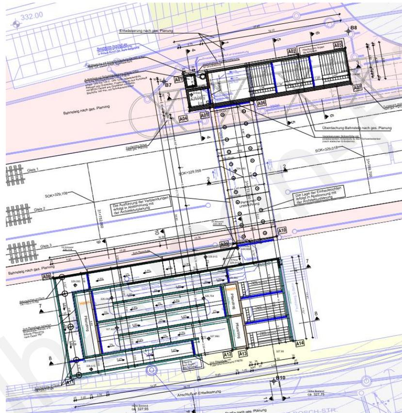
Unterführung – Grundriss Zugang Süd
